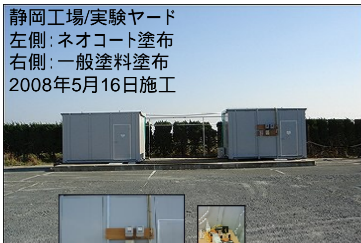
電力積算計、電力記録計を東棟、西棟に取り付け、電力量を記録。
